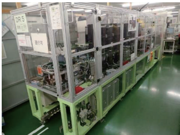
図6 【傷の気付きアルゴリズム】が実装された自動車部品検査装置の外観（愛知製鋼(株)西畑室長よりご提供）
